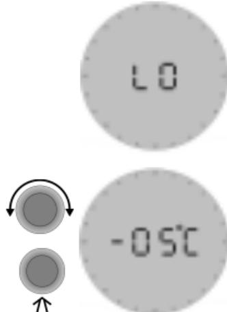
Режим (**OFFS**) позволяет выровнять расхождение в показаниях температуры на индикаторе терморегулятора и комнатном термометре.
