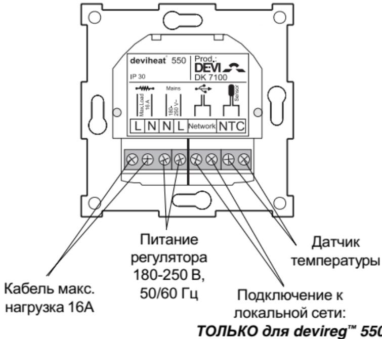
**Внимание!** Терморегулятор **devireg™ 540/550** не имеет специального контакта для подсоединения «земли». Вывод экранирующей оплетки кабеля должен соединяться с проводом «земля» питающей сети с помощью дополнительного контакта вне терморегулятора.
