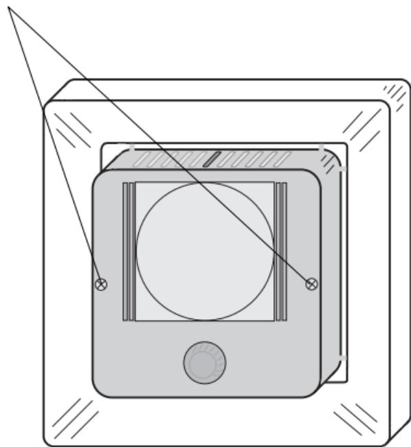
Соберите терморегулятор, начиная с установки корпуса, затем укрепите дисплей и установите на место лицевую крышку.
