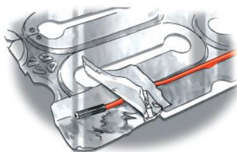
После установки и тестирования кабеля (см. инструкцию по установке нагревательных кабелей Deviflex™) постелите звукоизоляционную прослойку и установите деревянное покрытие. Придерживайтесь инструкций производителя покрытия!
