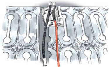
Накройте место прохождения кабеля еще одним куском алюминиевой фольги, отделив кабель от гофротрубы. Установите датчик на проводе в гофротрубу, заглушите её конец специальной насадкой или липкой лентой. Зафиксируйте гофротрубу на полу при помощи шурупов, клея или липкой ленты.
