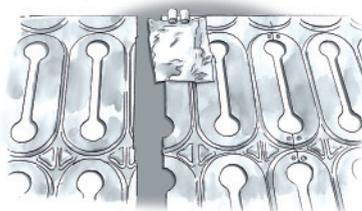
Установите и защелкните начало кабеля и гофротрубу. Подключение кабеля и терморегулятора должно проводиться сертифицированным электриком.
